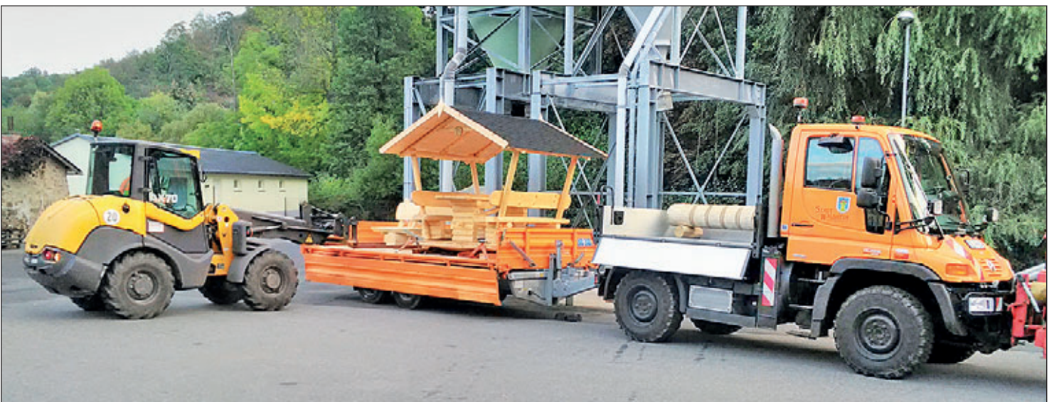
Die neue Grabenschleuder des Bauhofes wurde am Unimog angebaut. Damit können künftig die Straßengräben besser unterhalten werden und gleichzeitig für einen besseren Schutz vor Starkregenereignissen gesorgt werden.
