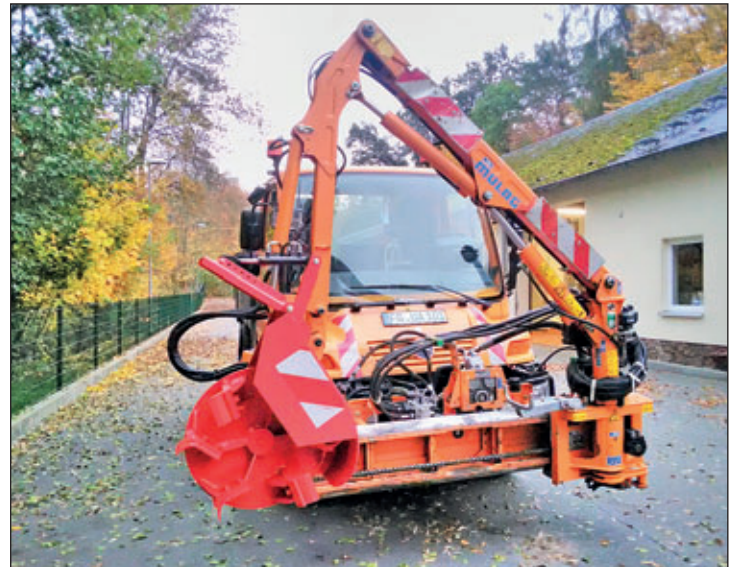
Die neue Grabenschleuder des Bauhofes wurde am Unimog angebaut. Damit können künftig die Straßengräben besser unterhalten werden und gleichzeitig für einen besseren Schutz vor Starkregenereignissen gesorgt werden.
