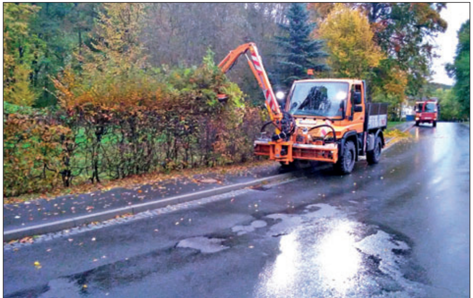
Derzeit sind die Mitarbeiter des städtischen Bauhofes mit Gehölz- und Heckenverschnitt beschäftigt, dabei kam auch ein hydraulisches Anbaugerät für den Verschnitt zum Einsatz.
